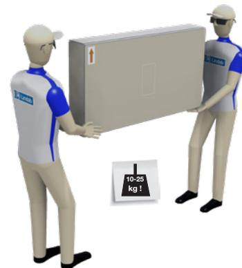
Verwenden Sie niemals die Rohrverbindungen oder die Kanten zum Anheben, weder wenn Sie sie auspacken oder zur Baustelle tragen.
